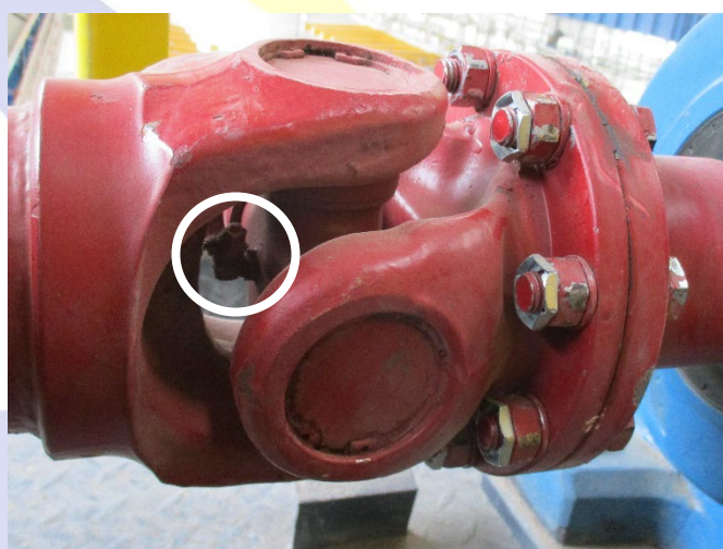
گریس کاری چهارشاخ گاردان از محل ۳
