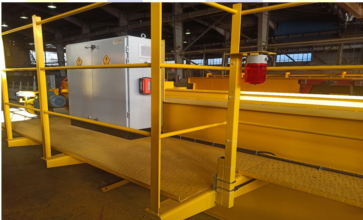
سالم بودن آژیر و چراغ گردان و تجهیزات هشداردهنده
