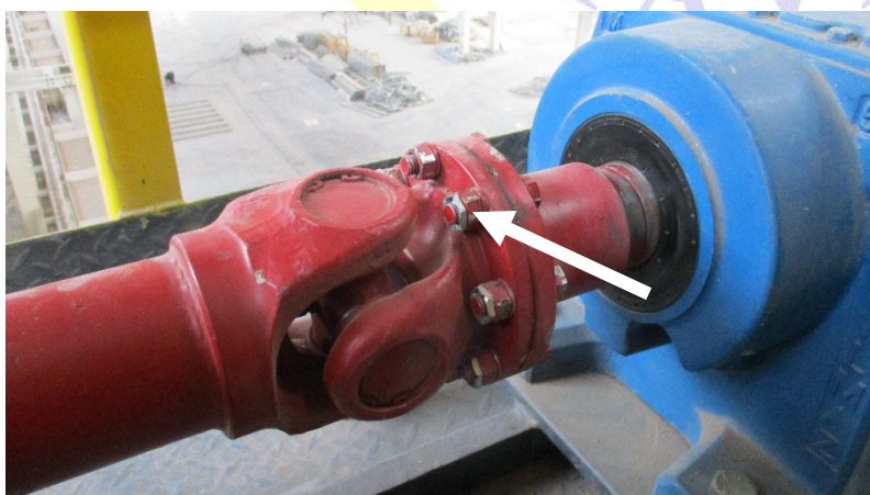
گریس کاری چهارشاخ گاردان از محل ۳
