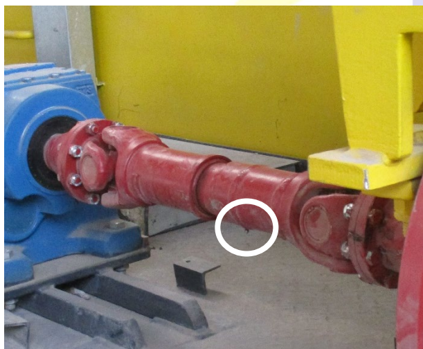
گریس کاری چهارشاخ گاردان از محل ۳
